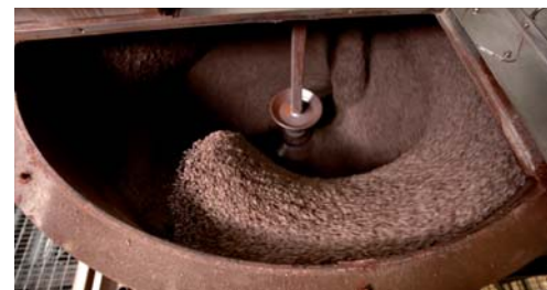
Porcja materiału siewnego żyta hybrydowego w trakcie cyklu zaprawiania realizowanego przez urządzenie firmy NIKLAS® 200
