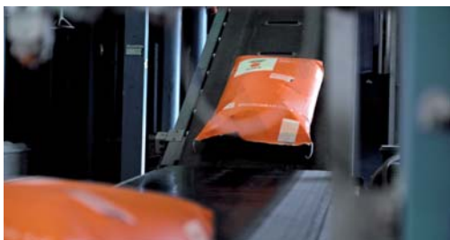
Zapakowany materiał siewny zmierza do maszyny układającej opakowania na paletach transportowych
